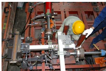
角締め金物強度試験
